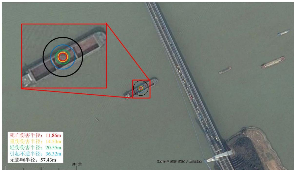
图 8.4-5 集装箱燃烧伤害范围（内河航道，1.3 项 1 号）
