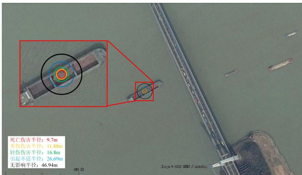
图 8.4-11 集装箱燃烧伤害范围（内河航道，1.4 项 1 号）
