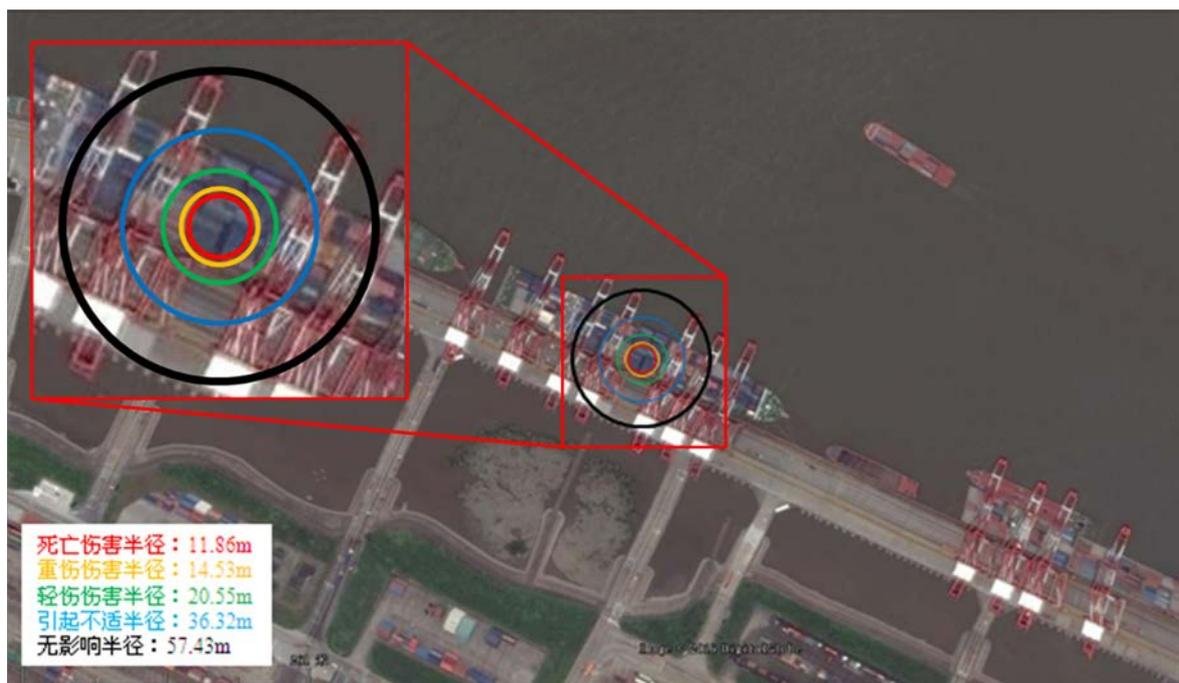
图 8.4-3 集装箱燃烧伤害范围（外高桥码头，1.3 项 1 号）
