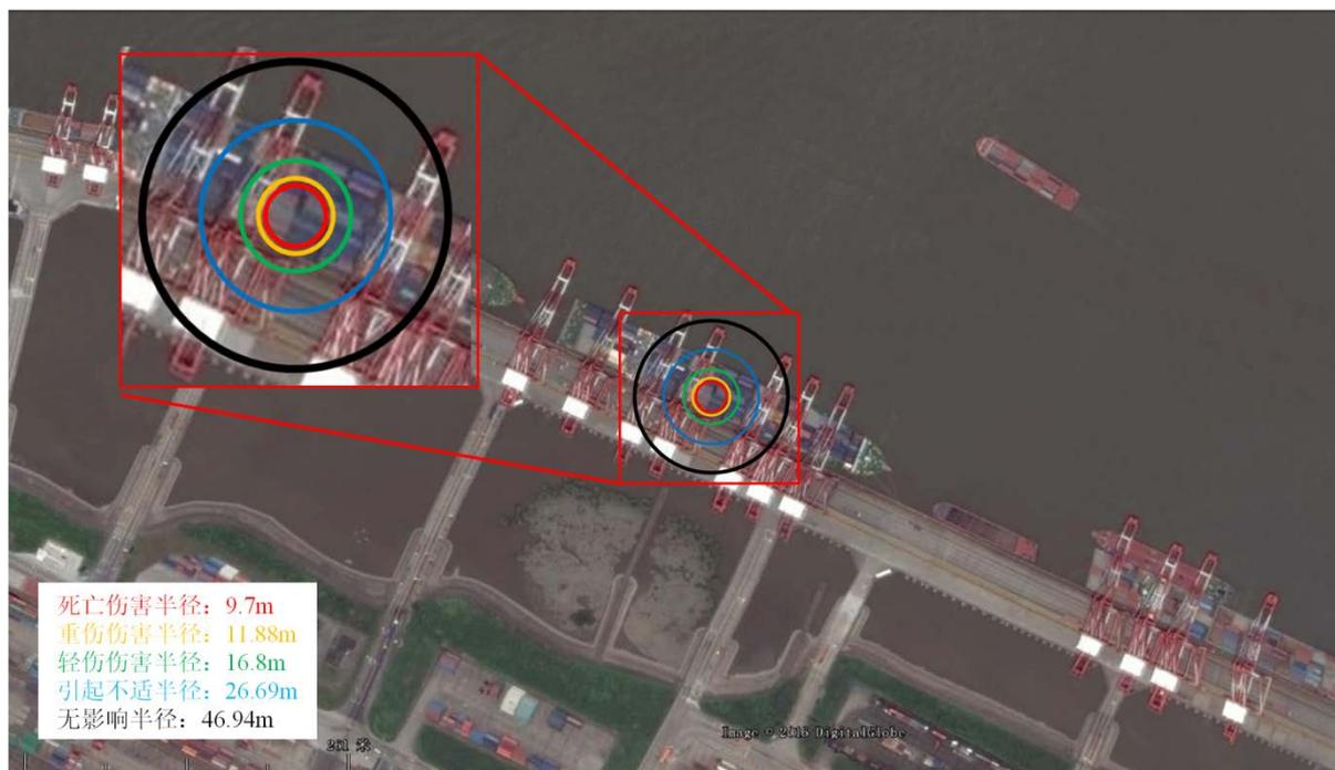
图 8.4-9 集装箱燃烧伤害范围（外高桥码头，1.4 项 1 号）
